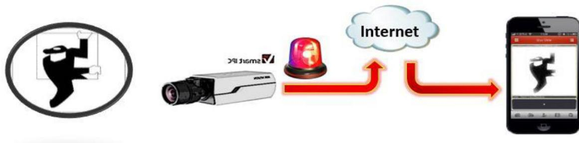
همانطور که در شکل بالا مشاهده میکنید، هنگامی که دوربین یک motion detect از پیش تعیین شده ای را می کند، از طریق بستر اینترنت یک آلامی به دستگاه موبایل شما ارسال می گردد. جهت این کار نیاز است که ابتدا تنظیمات لازم را در nvr انجام دهید.
